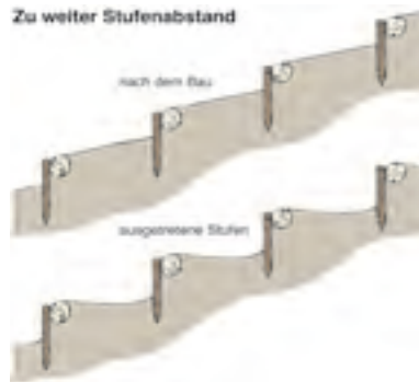
Austreten als Folge von zu weitem Stufenabstand.
