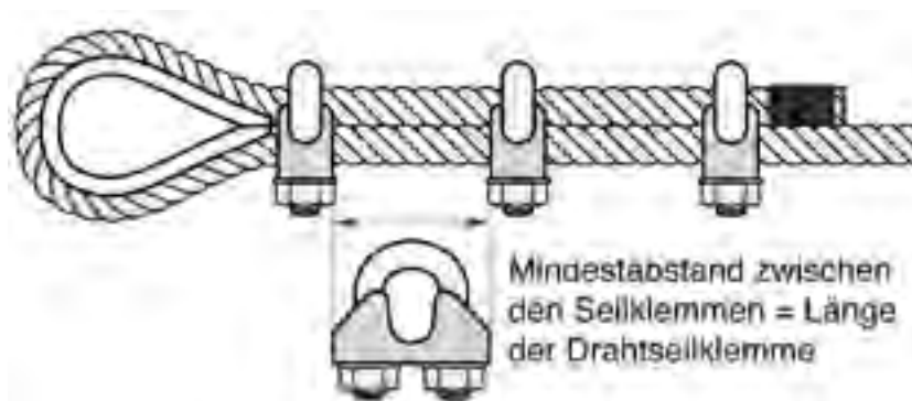
Drei Drahtseilklemmen für die Befestigung der Drahtseile im Endanker, die Klemmbügel befinden sich am unbelasteten Seilende.
